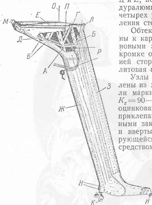
Рис. 48. Стойка коробки крыльев
